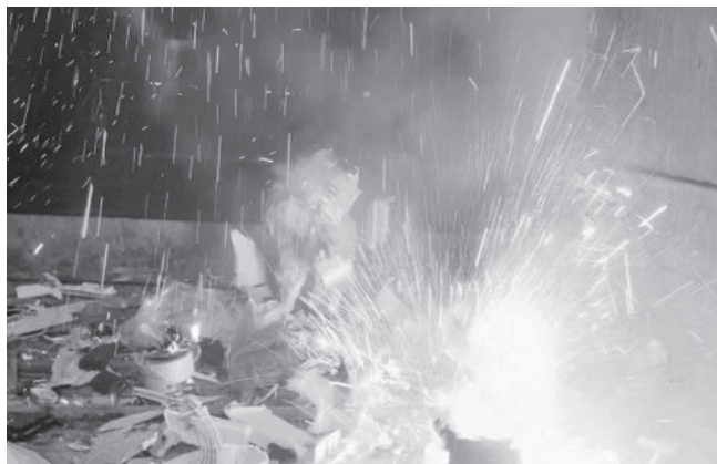
▲破砕実験により火花をあげて発火した リチウムイオン電池
