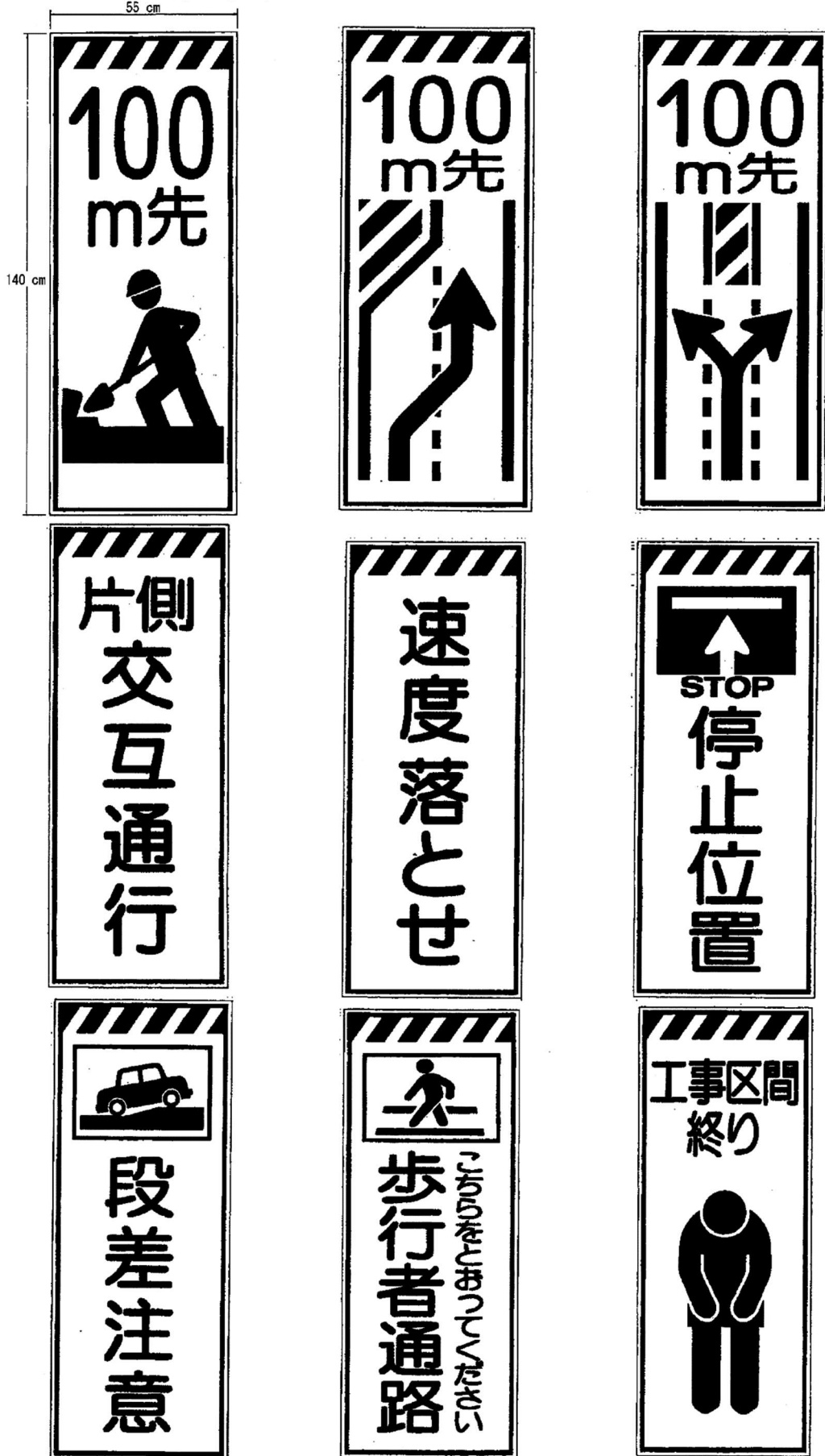
(様式-2) 工事予告標示板等
