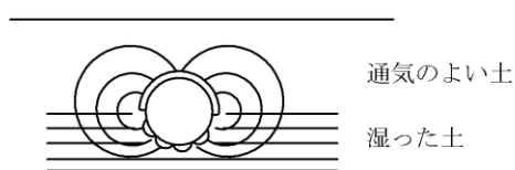
通気管によって生じる腐食
